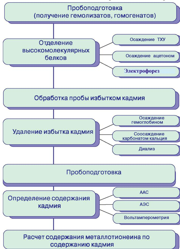
Рисунок 1 — Интегральная схема определения металлотионеинов в биообъектах
