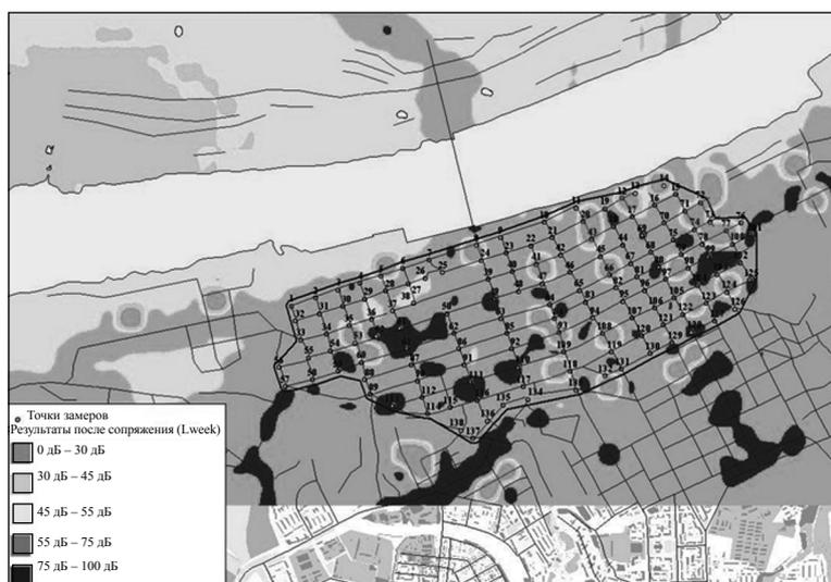
Рисунок — Карта-схема результатов акустического расчета с учетом инструментальных измерений в среднем за неделю
