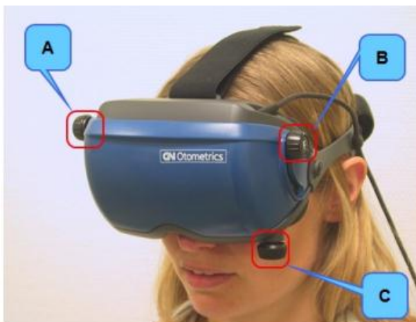
Рисунок 3. — Расположение ручек регулировки очков: ручка А — регулировка по горизонтали; ручка В — настройка фокуса изображения; ручка С — регулировка по вертикали
