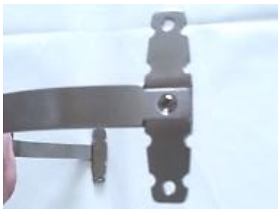
Рисунок 8 — Крепление боковых стабилизаторов к пластине
