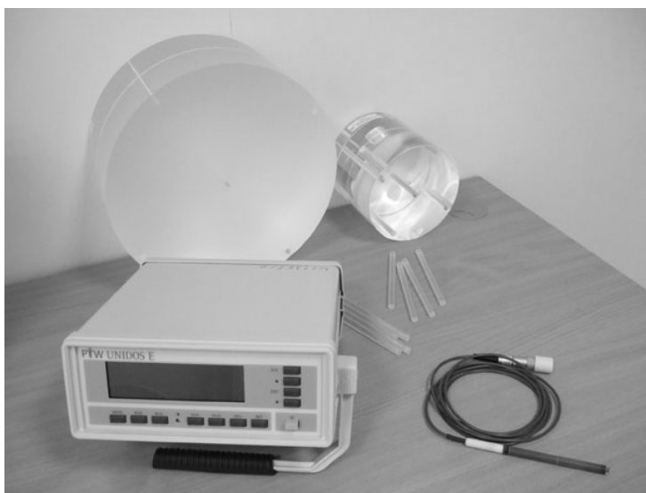
Рис. 1. Комплект оборудования для измерения доз облучения при КТ-исследованиях: фантомы для головы и туловища, дозиметр, ионизационная камера
