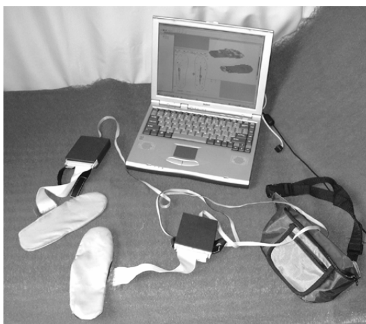
Рис. 1. Электронно-механический комплекс для диагностики патологии стоп
