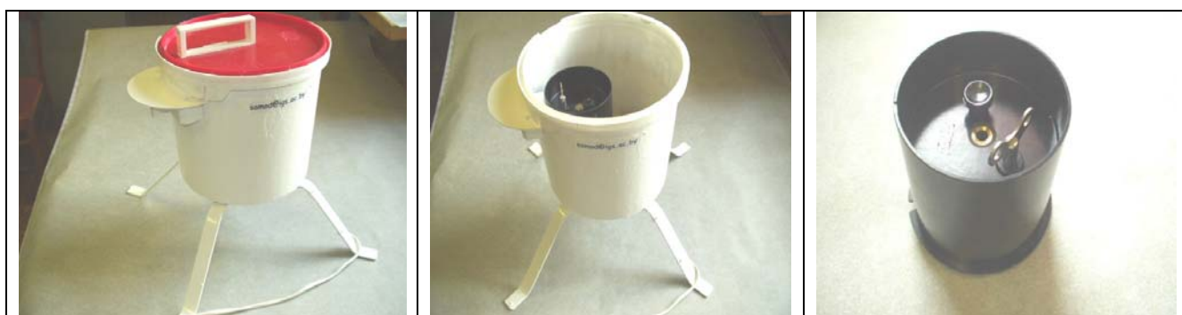
Рис. 2. Пылеуловитель. Слева – ловушка в сборе, в центре – крышка ловушки снята для смены ленты, справа – часовой механизм
