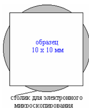
Рис. 6. Портативная импакторная ловушка для изучения образца в сканирующем электронном микроскопе (на поверхность столика наклеена двухсторонняя клейкая лента Scotch-3M)
