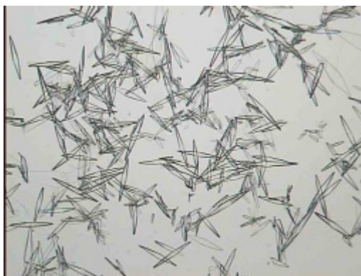
Рис. 6. Микрофотография кристаллов нитробарбитурата магния, осажденных из минерализата магнияммонийфосфатного камня. Увеличение x100
